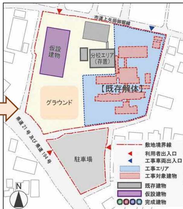
②既存建物の解体
