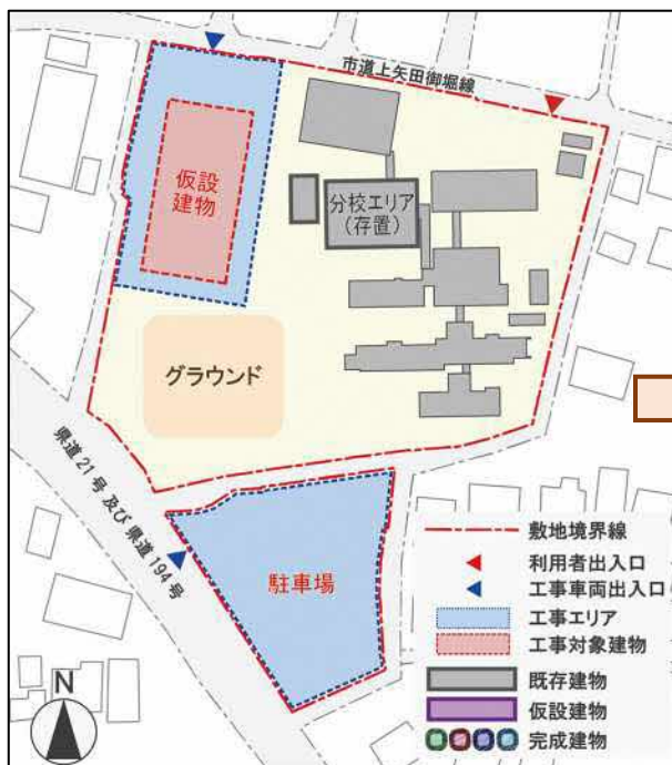
①仮設建物の建設+駐車場の整備
