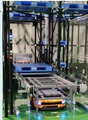
自動搬送ロボットが自動倉庫へ移動し資材を取り出す
