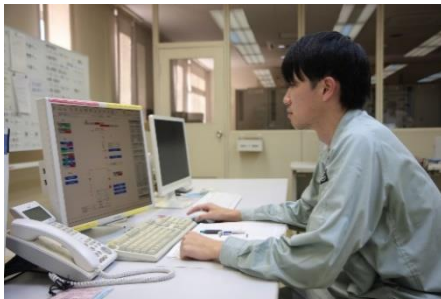
事務所(遠方監視操作室)で発電所の出力を増加させているところ
