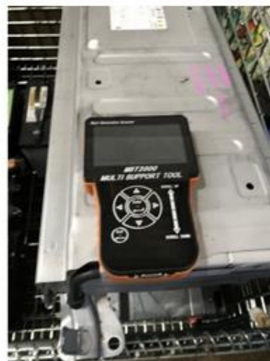
マルチサポートツール(MST2000) (自動車コンピューター診断ツール)
