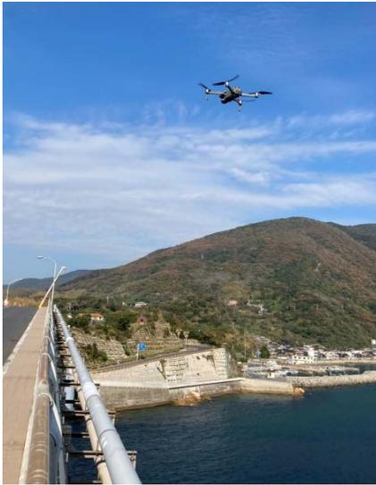
ドローンを使った桁外部の変状調査
