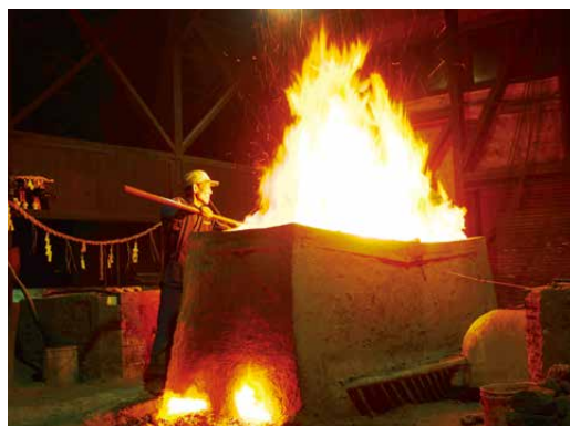
玉鋼製造(たたら吹き)伝承
