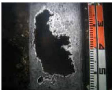
腐食による 鋼矢板開孔(44年経過)
