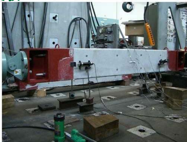
写真2.5 直接引張試験
