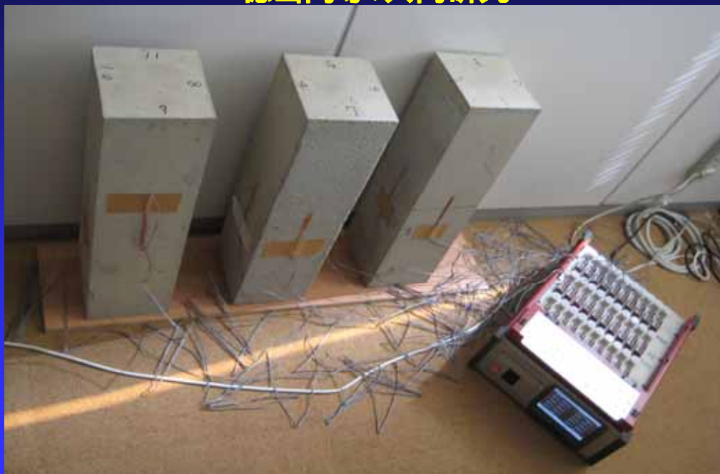
図13 ひずみゲージを用いた簡易乾燥収縮試験
