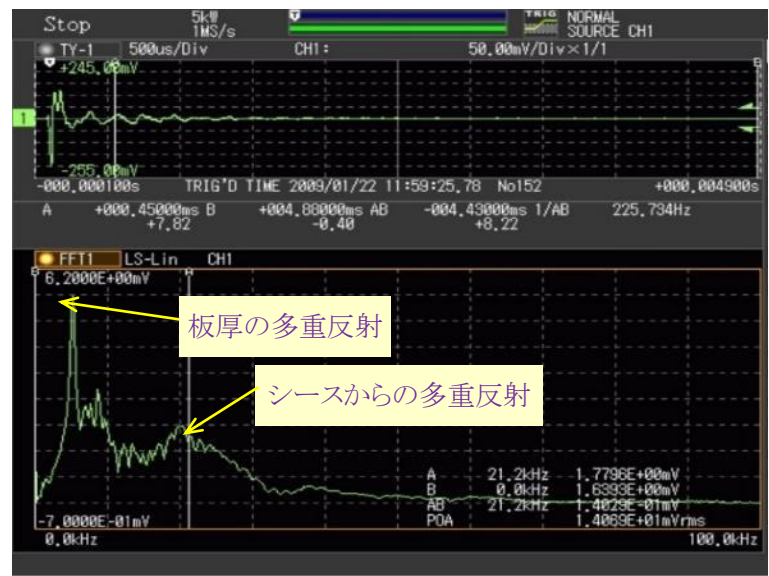
グラウト充填度と受信波の周波数スペクトル
