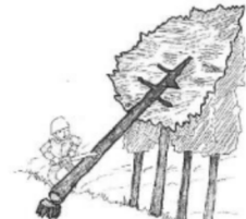
(図5) かかっている木の元玉切り
