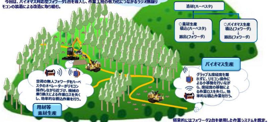
図 1-3 用材+森林バイオマス省力搬出作業システム
