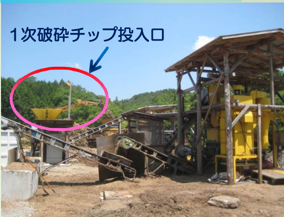
写真 4：1次破碎チップから2次破碎チップへ製品化（50mm以下）
