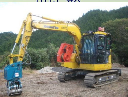
写真 4：スイングヤード(0.25㎡) H26.3 リース
