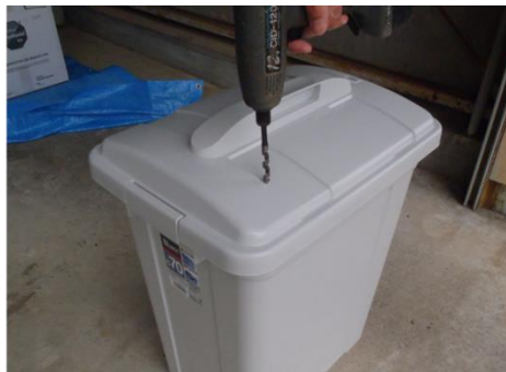
電動ドリルで穴を開ける
