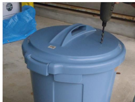
電動ドリルで穴を開ける
