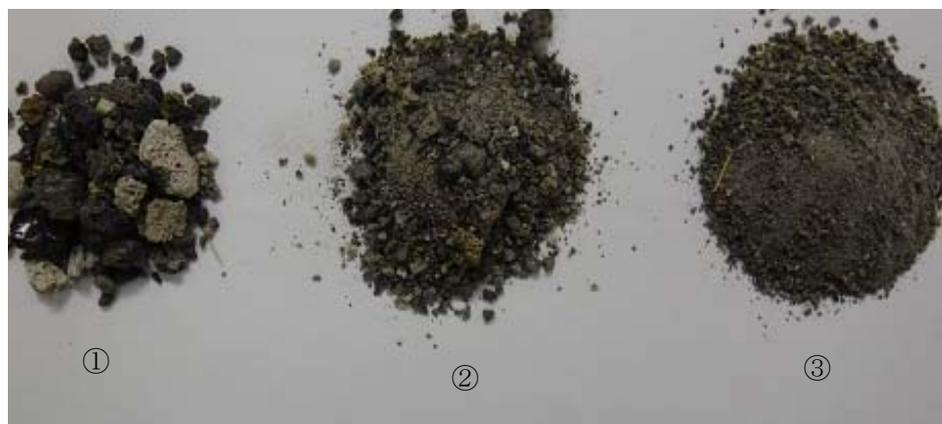
図1 クリンカアッシュの粒径状況
