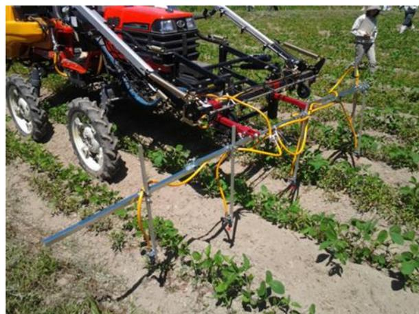
吊り下げノズルによる防除作業
