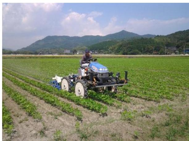
ディスク式中耕除草機による中耕培土作業
