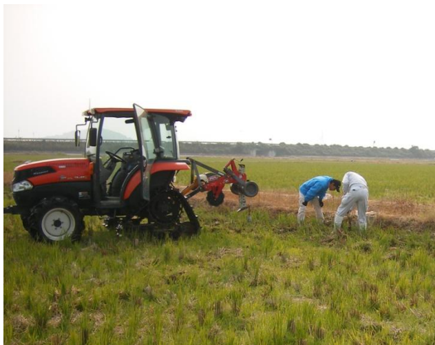
写真2 放射状弾丸暗渠施工前の排水溝掘り下げ
