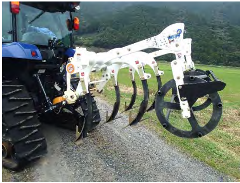
図1 チゼルプラウ 写真の機種は5本爪で30~50馬力のトラクタに適應。
