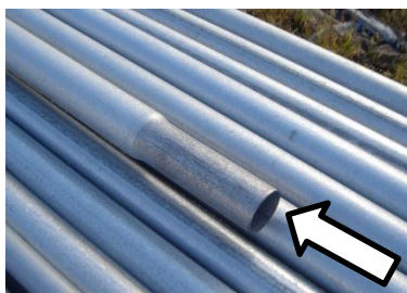
直管のスエジ(頭側)
