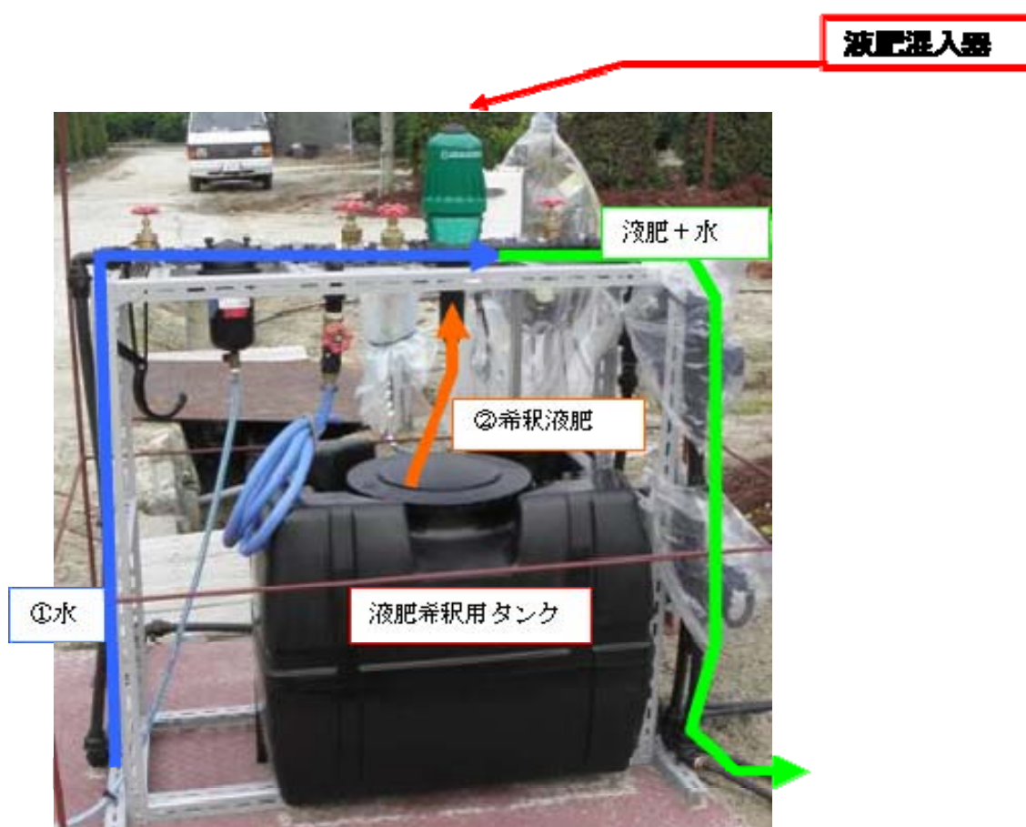
図15 液肥混入器の設置例
