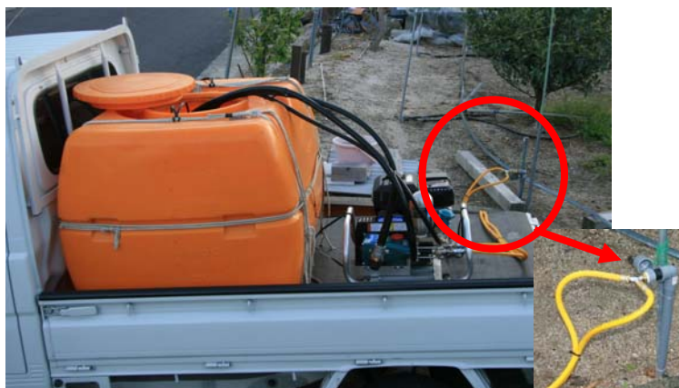
図8 トラックに動力噴霧機とタンクを積んで給水する事例 ホースの接続口を改良(下)
