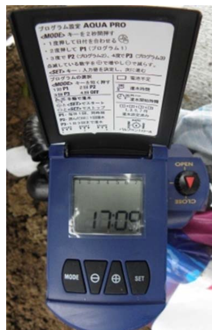
図14 電磁弁(灌水制御機)
