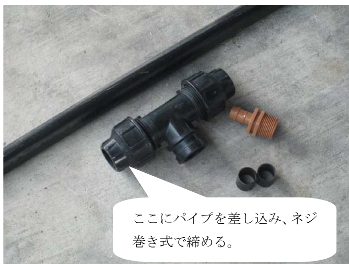
図10 ポリエチレン製パイプの接続 ネジ巻き式のため、キャップを外せば 容易に着脱が可能である。
