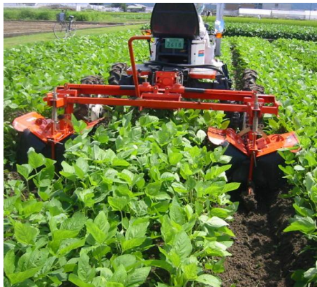
土入れ 乗用管理機で溝部分の土を畦上に飛ばし子葉節までかかる程度に実施
