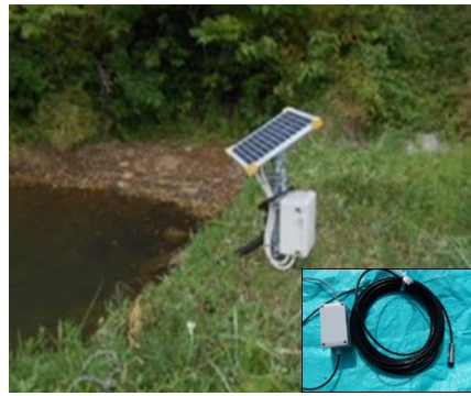
図2 遠隔監視システム（圧力式）
