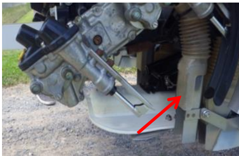
図 5 側条施薬機付移植機の写真 (矢印が側条施薬機)
