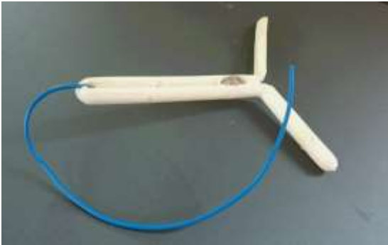
図1 試作した体温測定器（シダー中央部にデータロガー装着）
