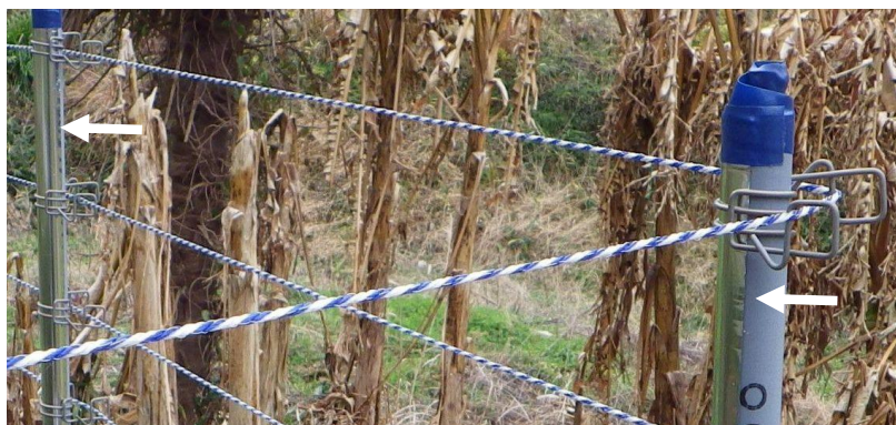
第9図 導電性テープの状況 2016年2月1日現在 (2014年2月25日設置から706日後)
