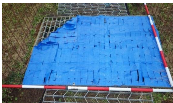
第12図 グレーチング用カバーの形状
