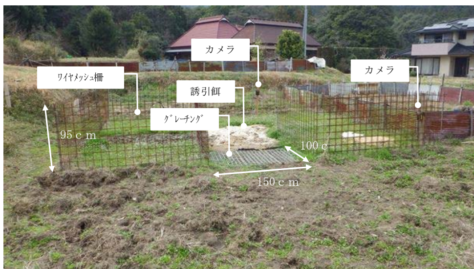
第4図 野生イノシシによるシカ用グレーチングの歩行試験
