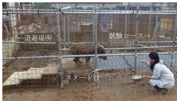
第3図 飼育イノシシによるシカ用グレーチング歩行試験
