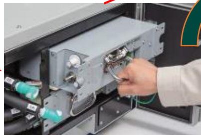
1つのカセットに 3つの水素吸蔵合金 (17 kg / カセット)
