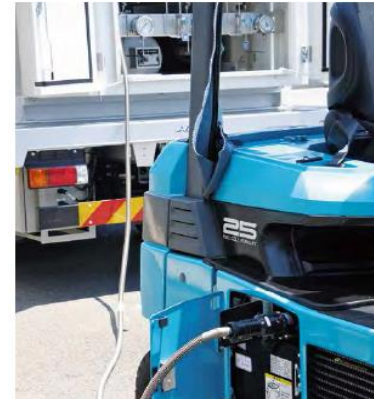
燃料電池フォークリフト (ビール工場等に設置)
