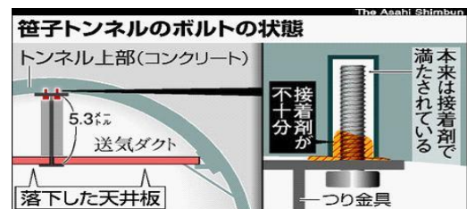
笹子トンネル天井板落下事故 (2012年12月2日) ボルトの状態
