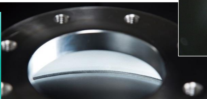
自動溶接システムを活用した溶接裏波
