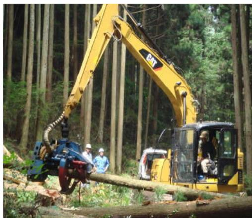
高性能林業機械（ハーベスタ）による造材作業
