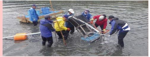
当センターでは、国の研究事業（農研機構生物系特定産業技術研究支援センター「攻めの農林水産業の実現に向けた革新的技術展開事業（うち産学の英知を結集した革新的な技術体系の確立）」の委託を受けて、広大な陸上池（面積 1.5ha）でのアサリ人工種苗生産技術の開発に取り組んでいます。この技術開発の一環として、平成 26 年 11 月、陸上の池で生産したアサリを効率よく回収するための曳き歩き式噴流ジョレン（本体重量：35kg、籠重量：10kg、回収機の有効幅 80cm、曳走速度 20m/min.）を開発しました。
