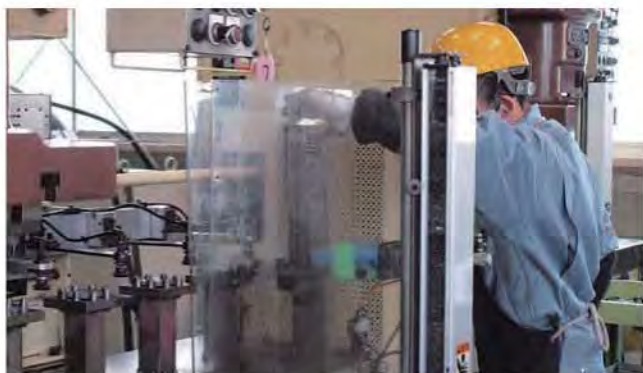
プレス機械に手が入る事故を防ぐため、アクリル板で囲んでセンサーを取り付けている
