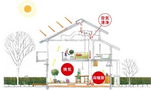
太陽熱利用空調システム OMソーラー(床暖房・給湯・換気)
