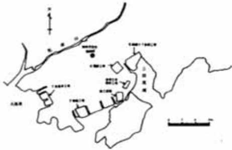
図14 防府地区の立地条件および大気汚染測定地点
