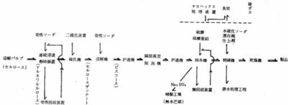
図2 レーヨンステーブル製造工程
