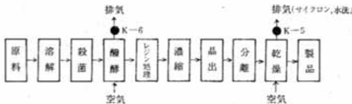
図5 アミノ酸製造工程フローシート
