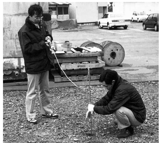
図2 土壌ガス法による地下水汚染調査（当時）
