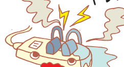
トラッキング現象
