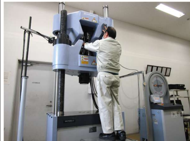
万能材料試験機による強度試験
