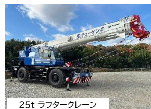
25t ラフタークレーン
