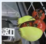
トマトロボットのハンドメイド試作品において、トマトを傷つけないようにシリコン製の手先を製作し動作チェックをしている様子。
