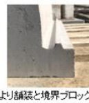
突起の形状により舗装と境界ブロックが剥離し難くなり雑草の繁殖を防ぎます
