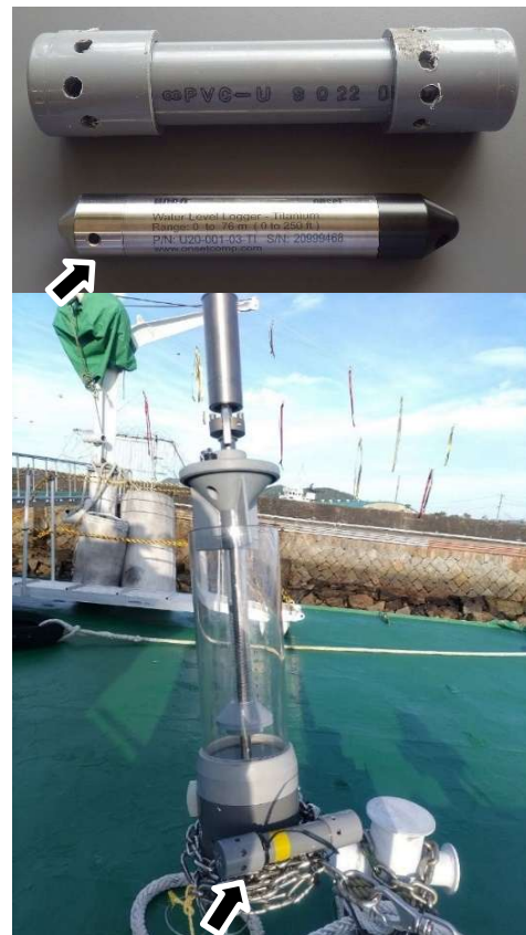
図1 上: 水深水温ロガーと保護ケース、下: 採水器へのロガー取付状況(矢印はセンサの圧力検出部位置を示す)
