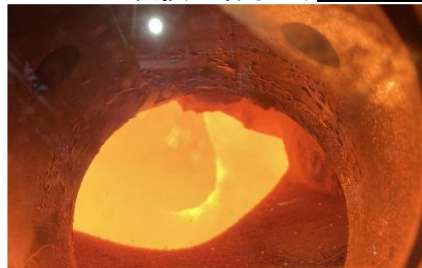
セメント焼成時のアンモニア混焼実証 ※県内企業による世界初となる実機設備を用いた商業規模での実証試験
