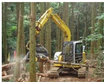
ハーベスタによる丸太の採材作業
