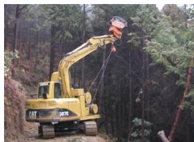
スイングヤーダによる集材作業
