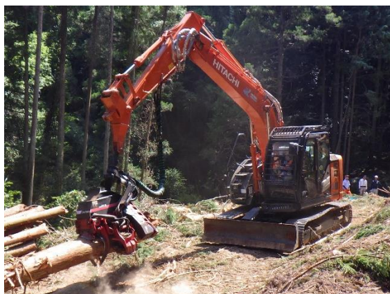
ICT ハーベスタによる造材作業
