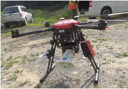
▲ ハンティングドローン実証機 (高出力スピーカー・煙火発射装置搭載)
