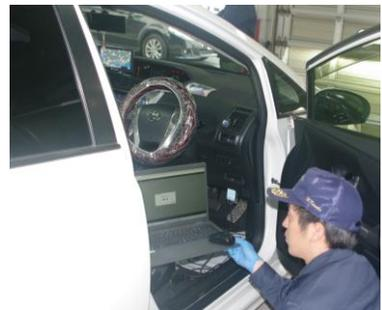
【車載式故障診断装置からのデータ抽出状況】
