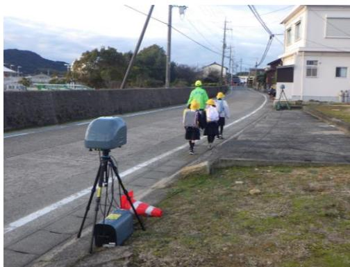
可搬式速度違反自動取締装置による取締り状況
