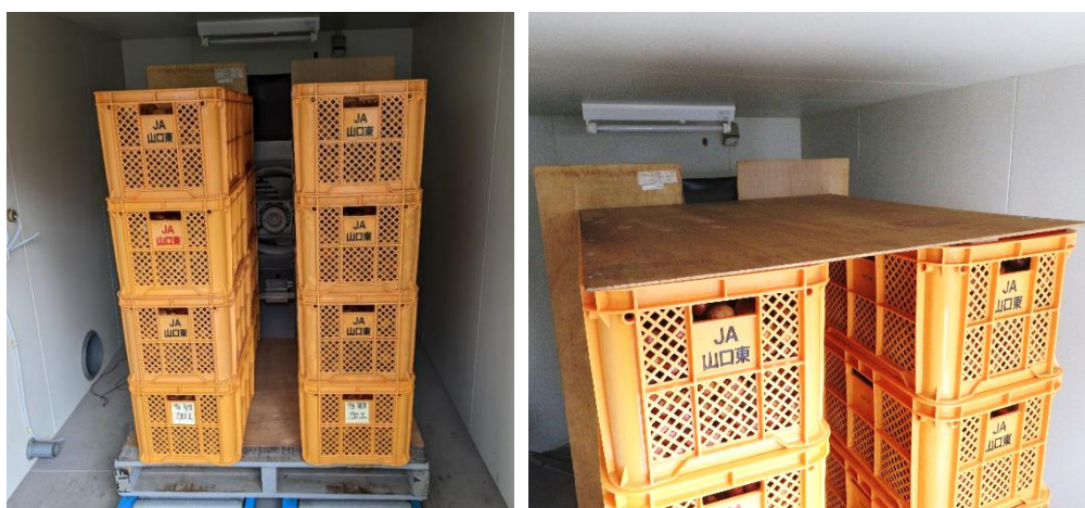
図 3 上面と出入口側の仕切り板を設置する前の状態(左)、上面の仕切り板を設置したところ(右)
