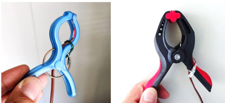
図 13 センサーを固定した大型クリップの例
