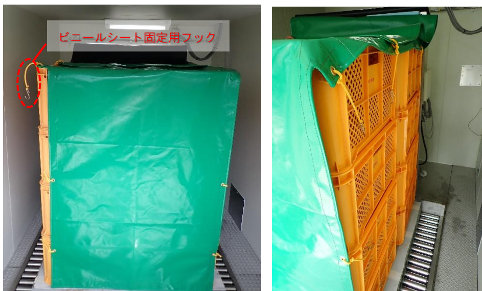
図 4 コンテナに専用のビニールシートを被せたところ(左)とその側面(右)
