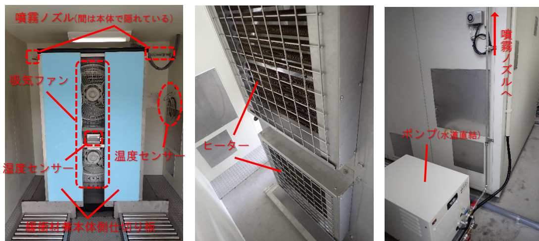
図 1-1 クリ用蒸熱処理機の主要部(左から本体表、本体裏、ポンプ)
